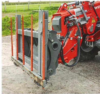
Praktisch: Der Ballenspieß lässt sich für den Straßentransport einfach klappen.
